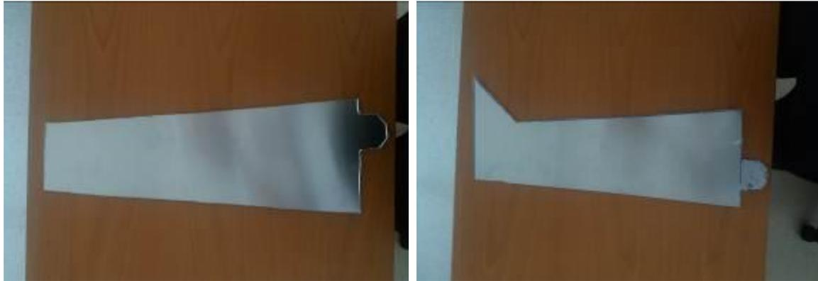
Gambar 5. Bentuk Awal Baling-Baling Model NACA 4412
