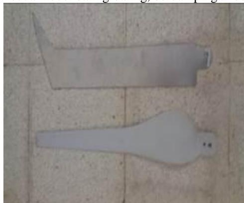
Gambar 7. Perbandingan Model Baling-Baling dengan Kesamaan Luas Penampang
