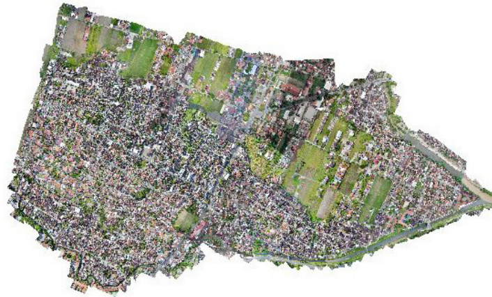
Gambar 2. Hasil mozaik blok 1 sampai blok 50 dengan foto udara menggunakan software agisoft photoscan pro di Kelurahan Sumber.
