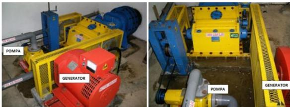
Gambar 12. Turbin memutar pompa dan generator
