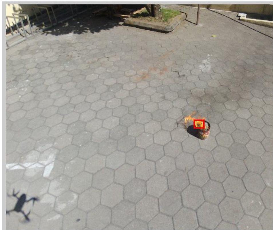
Gambar 6. Sampel Citra Api yang terdeteksi pada ketinggian 2 meter
