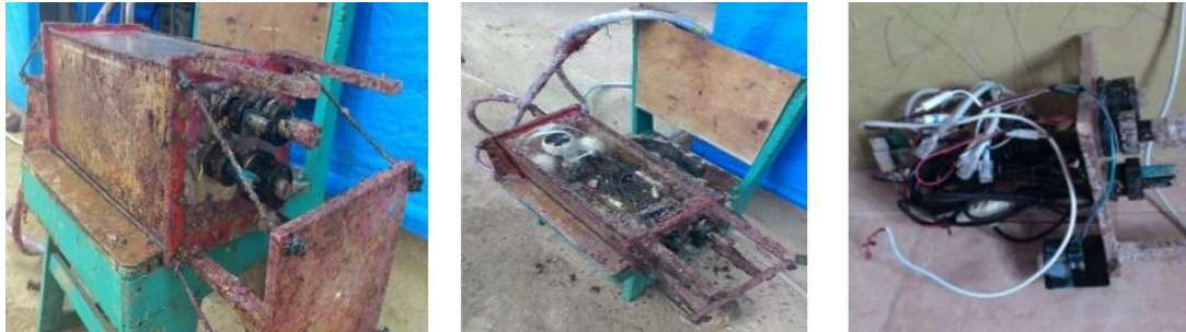
Gambar 1. Prototype terdahulu yang terkontaminasi biofouling
