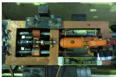
Gambar 2. Alat pencekam sekaligus sistem hidrolis las gesek
