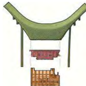
Gambar 1. Pembagian Struktur Tongkonan (sumber: Oktawati dan Sahabuddin, 2016)
