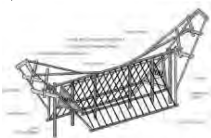
Gambar 11. Konstruksi Atap Rumah Tongkonan (sumber: Oktawati dan Sahabuddin, 2019)
