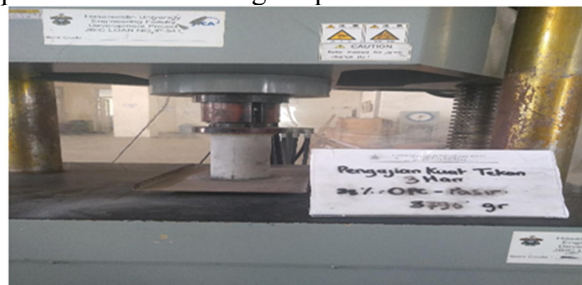
Gambar 4. Pengujian kuat tekan beton
