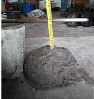
Gambar 3. Pengukuran slump beton segar
