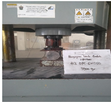
Gambar 6. Pengujian tarik belah belah beton
