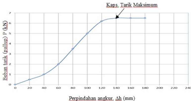
Gambar 5. Grafik kapasitas tarik batas untuk kedalaman 300 mm
