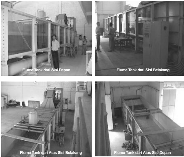
Gambar 12. Flume Tank yang digunakan untuk uji model
