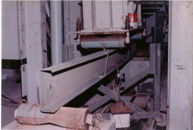
Gambar 4. Deformasi balok tanpa pengaku longitudinal ; P=600 kg (5880 N), (Sugihardjo, 1996)
