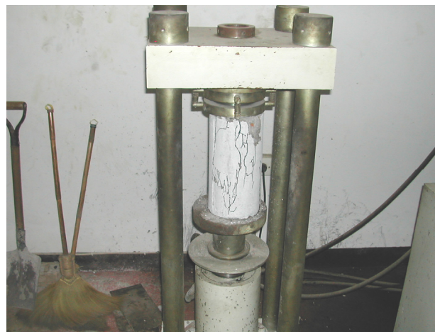
Gambar 2. Foto retaknya beton uji
