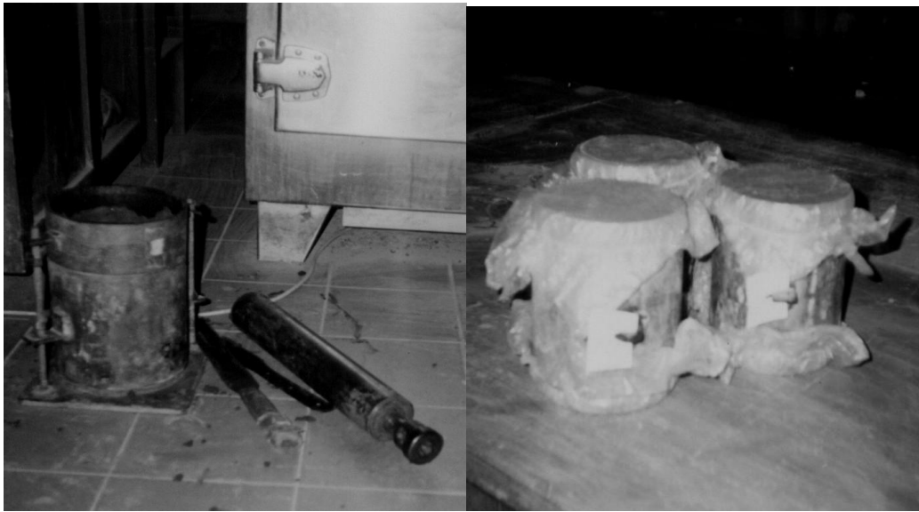
Gambar 2. (a) Pemadatan campuran tanah dengan kapur. (b) Perawatan benda uji selama 3 hari.
