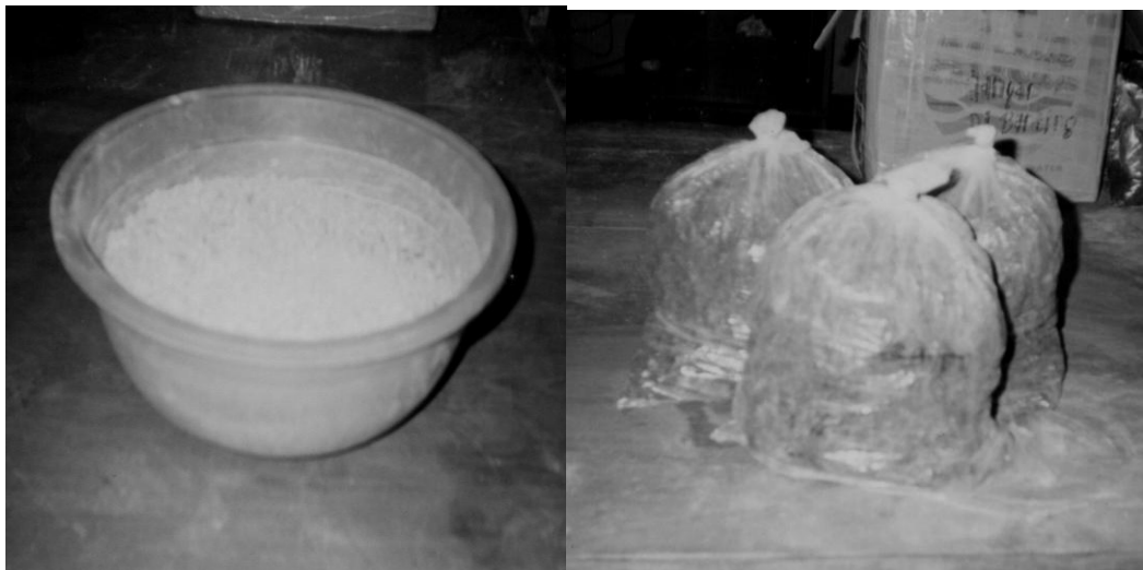
Gambar 1. (a) Pencampuran tanah dengan kapur. (b) Pemeraman campuran selama 24 jam dan 2 jam.
