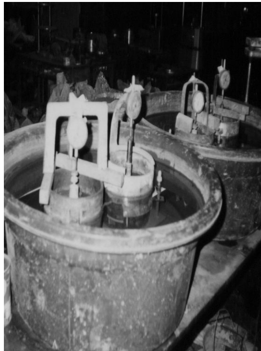
Gambar 3. Perendaman benda uji selama 4 hari.
