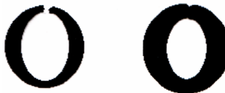
Gambar 6. Proses dilation digunakan untuk menyambungkan objek yang terpecah.
