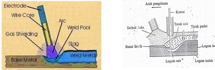
Gambar 2. Proses pengelasan busur logam terbungkus (Aljufri, 2008)
