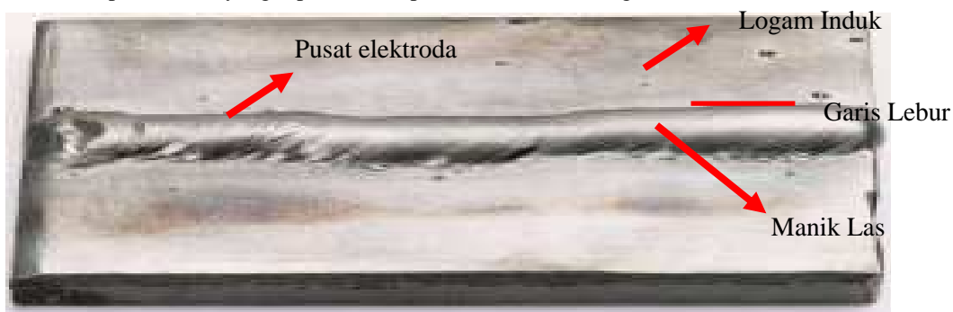
Gambar 3. Arah pembekuan dari logam las
