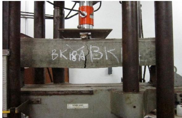
Gambar 4. Balok beton bertulang setelah diuji lentur dan patah di tengah-tengah bentang
