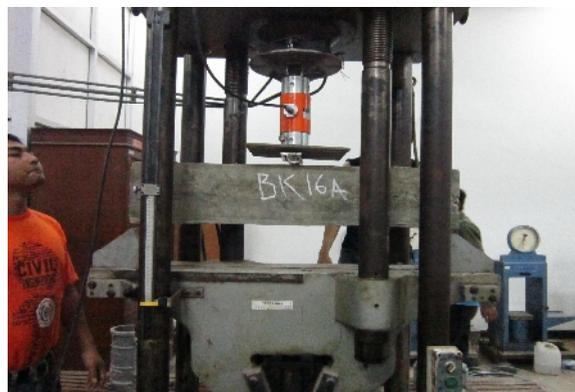
Gambar 3. Balok beton bertulang sebelum diuji lentur
