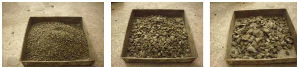
Gambar 5. Foto material RAP yang telah dipisahkan menurut ukurannya
