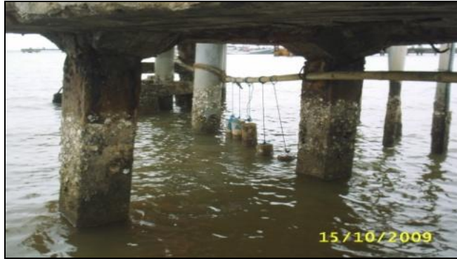
Gambar 6. Penempatan benda uji di daerah splash zone laut, wilayah laboratorium kelautan Undip di Jepara
