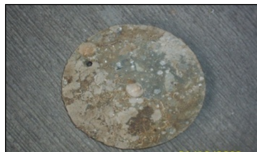
Gambar 4. Benda uji lempeng beton
