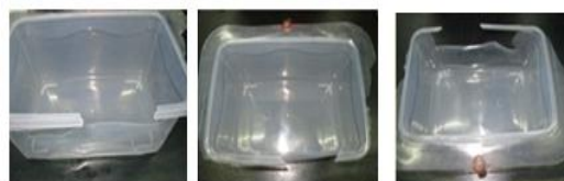
Gambar 4. Cacat dinding tebal tipis pada Body Sealpack
