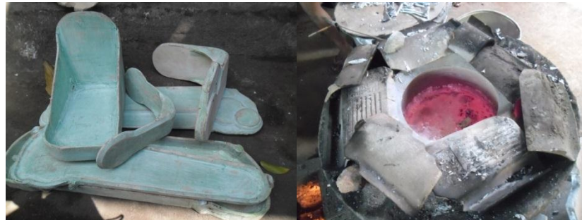
Gambar 2. Cetakan arm robot Gambar 3. Proses pelelehan aluminium
