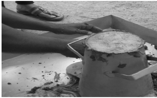
Gambar 4. Melakukan uji slump
