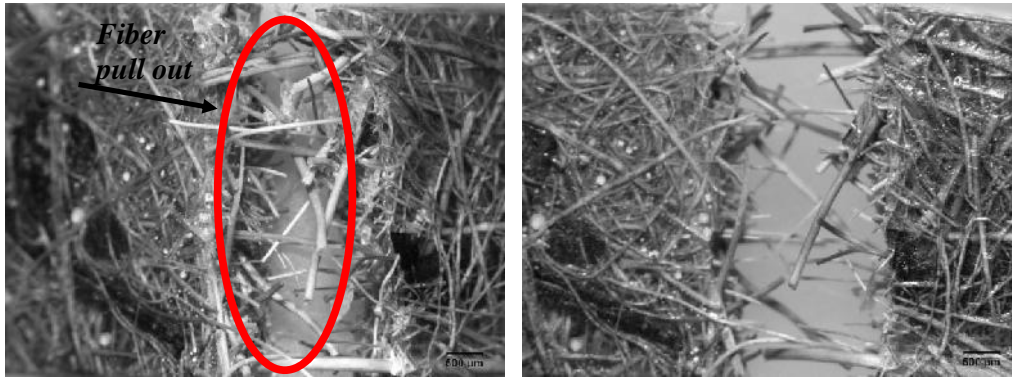
Gambar 4. Patahan komposit yang diperkuat serat dengan perlakuan alkali 1 jam
