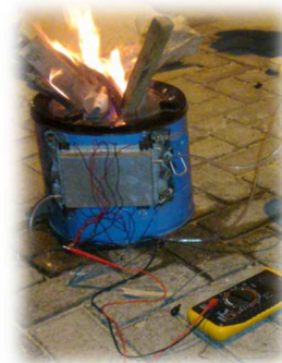
Gambar 10. Instalasi alat ukur tungku gasifikasi biomasa
