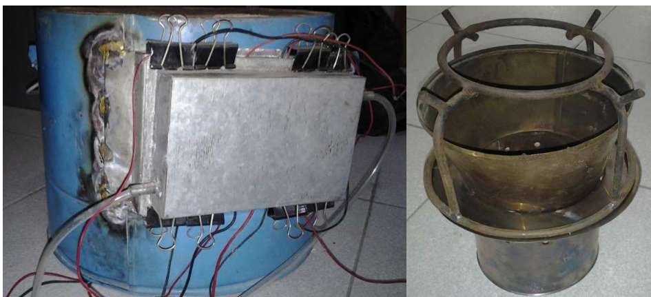
Gambar 16. Manufaktur tungku gasifikasi biomasa beserta ruang feedstock
