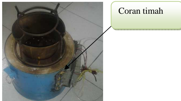
Gambar 17. Coran timah agar kontak dinding tungku optimal dengan termoelektrik
