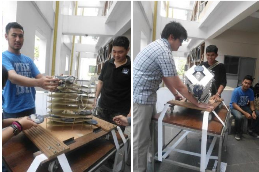
Gambar 12: Proses dari pembebanan hingga rangkaian goyangan sampai mengalami kerusakan pada struktur
