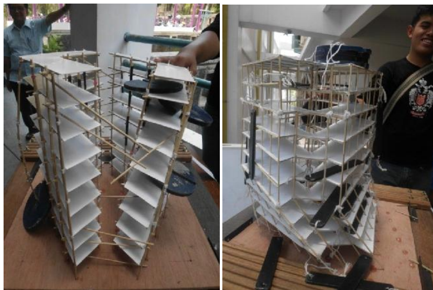
Gambar 13: Ini beberapa makat hasil uji gempa bumi terlihat berbagai jenis kerusakan dan mulai dipikirkan langkah penanggulangannya.
