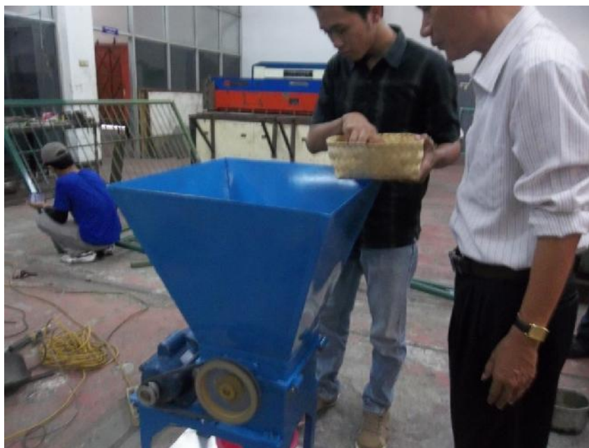
Gambar 7. Pengujian penggilingan garut dengan rotary crusher
