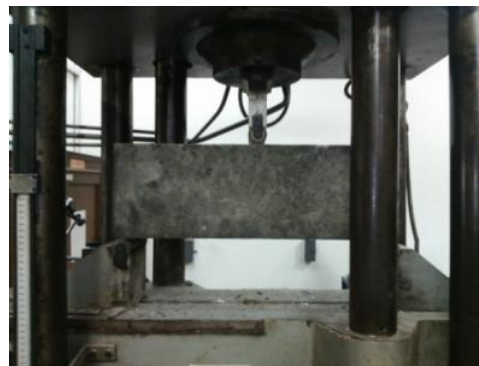
Gambar V-9 Pengujian kuat lentur beton
