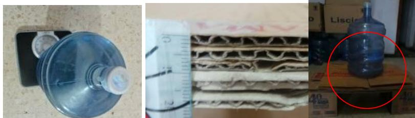
**Gambar 2. Proses percobaan tahan beban
