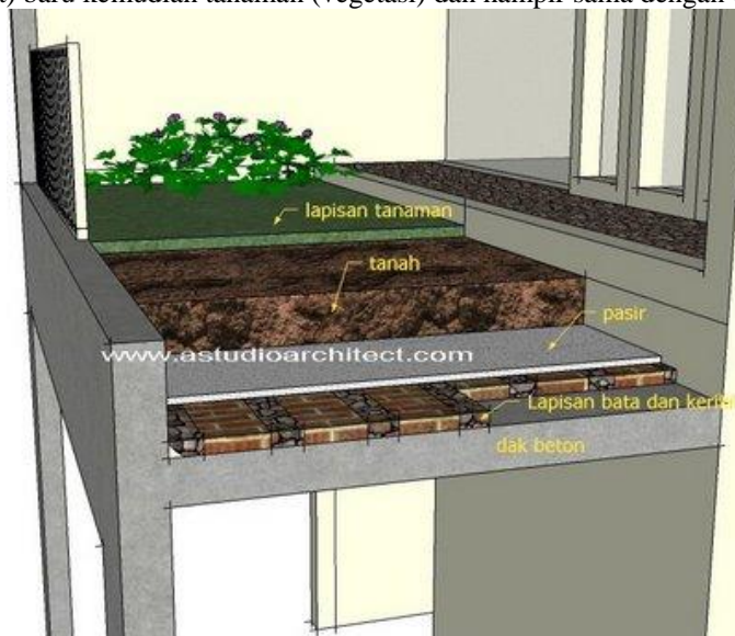
Gambar 13. Struktur tanaman pada atap bangunan gedung.
