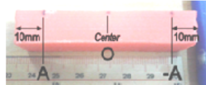
Gambar 7. Tiga posisi pengujian dengan alat uji kekasaran.
