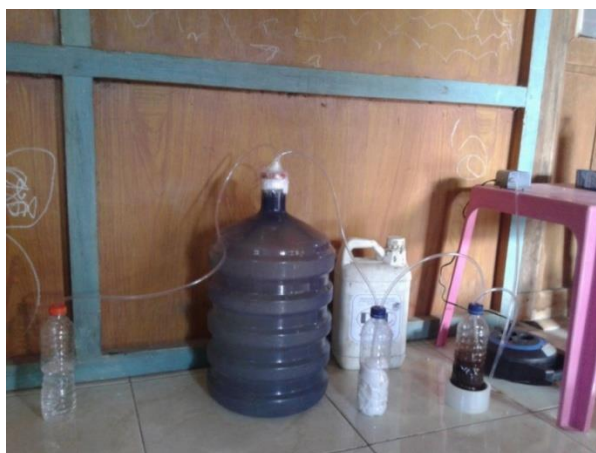
Gambar 1. Rangkaian peralatan sederhana produksi B. bassiana media cair
