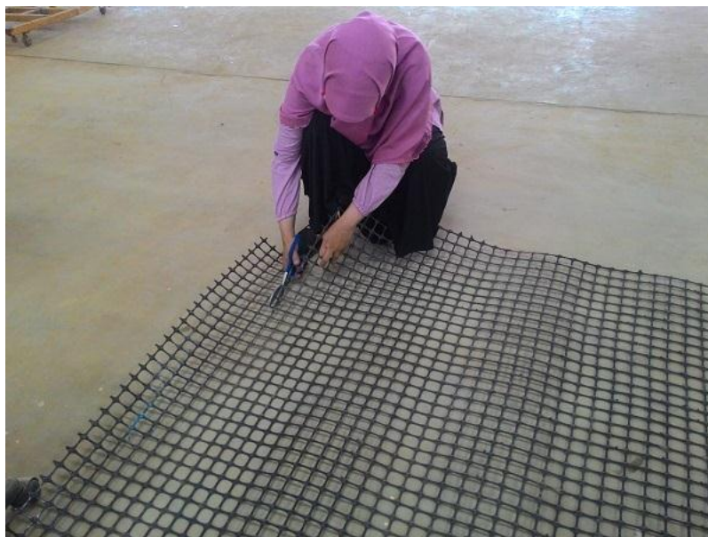
Gambar 1. Geogrid yang dipergunakan dalam pengujian
