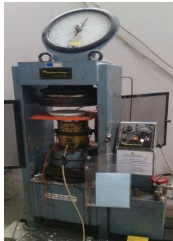
Gambar 5. Setup pengujian nilai-kv SAMI-RC dengan mesin uji tekan
