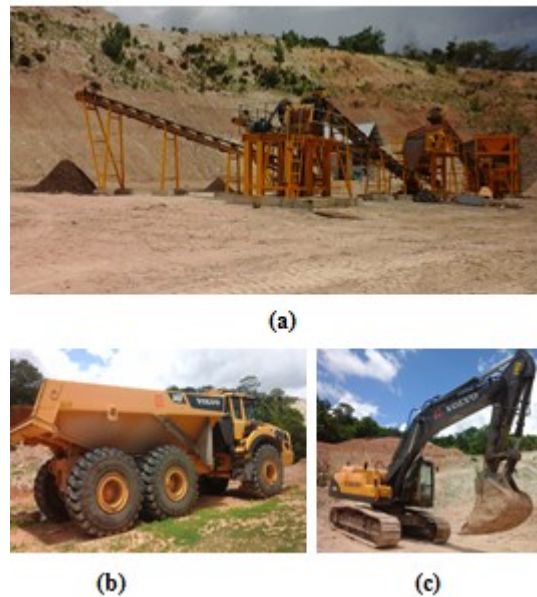
Gambar 11. Peralatan tambang di PT HAN (a) Crusher (b) Dump Truck (c) Ekskavator
