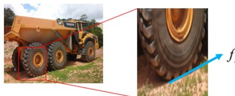
Gambar 14. Penerapan gaya gesek pada ban dump truck Prinsip momen gaya saat dump truck menurunkan material mangan dapat dijelaskan berikut.
