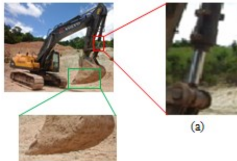
Gambar 12. Proses fisik pada ekskavator. (a) penerapan hukum Pascal, (b) penerapan prinsip tekanan.
