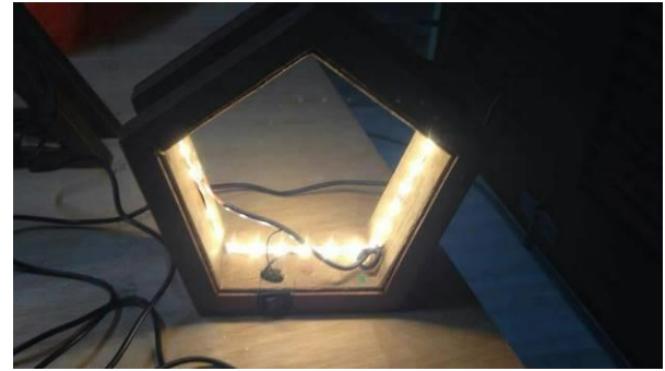
Gambar 11. Pemasangan Lampu LED. Lampu menggunakan lampu LED hangat yang hemat energi.
