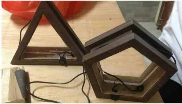
Gambar 10. Rangka Lampu Tidur yang sudah diberi finishing
