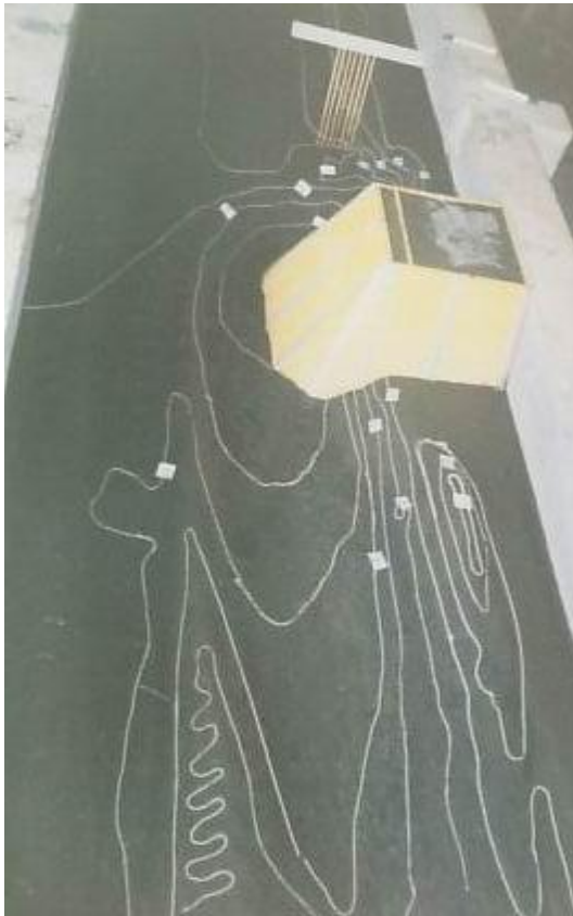
Gambar 13. Posisi tirai di hulu abutmen dengan sisi pinggir pas kaki bantaran
