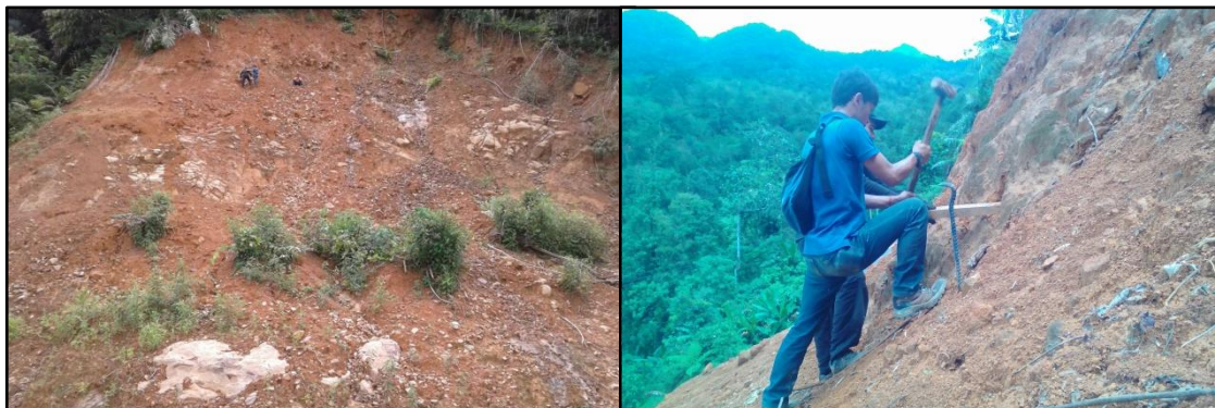
Gambar 5. Kondisi longsor pangkalan pada(kiri), pengambilan sampel tanah tak terganggu (kanan)
