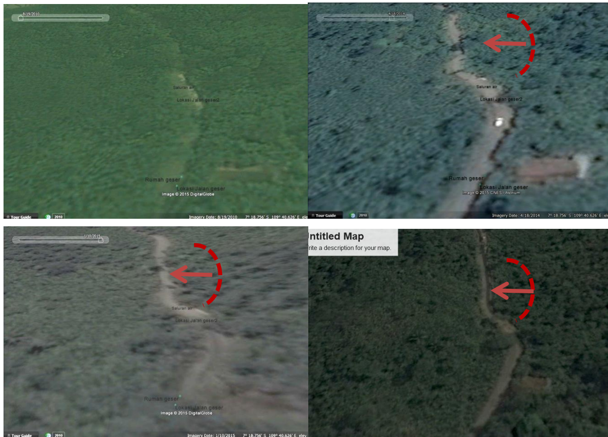
Gambar 8. Proses pergeseran jalan dari waktu ke waktu lokasi longsor, diambil dari google.earth: (a) 2004; (b) 2014 ; (c) 2015, dan (d) 2018, tampak ruas jalan bergeser ke arah kiri atau barat dari tahun 2004 hingga 2015
