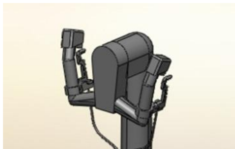
Gambar 2. Desain alat kemudi rudder berbasis kendali tangan
