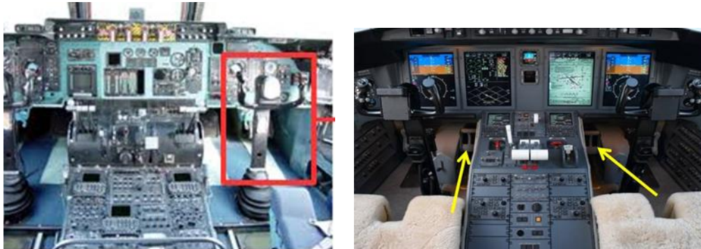
Gambar 2. Posisi control column dan rudder pedals saat ini pada cockpit
