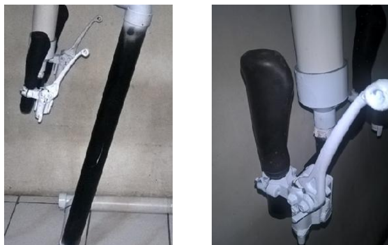
Gambar 4. Tampilan fisik alat kemudi rudder berbasis kendali tangan
