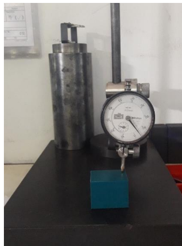
Gambar 8. Pengukuran geometri dengan Dial Indicator
