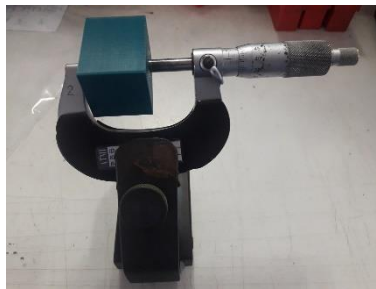
Gambar 7. Pengukuran dimensi dengan Outside Micrometer
