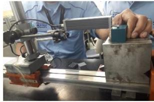
**Gambar 11. Pengukuran produk dengan *surface roughness tester***
