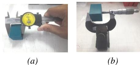
**Gambar 9. (a) Pengukuran produk dengan jangka sorong, (b) Pengukuran produk dengan *outside micrometer***
