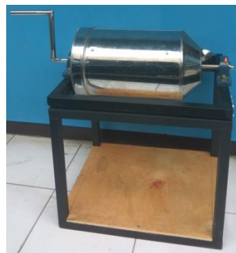
Gambar 6. Hasil pembuatan alat sangrai melinjo
