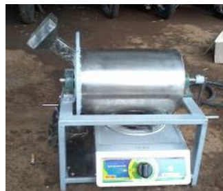
Gambar 3. Alat sangrai kopi dengan tuas pemutar
