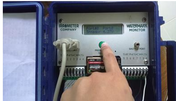
Gambar 3: Pembacaan kadar air pada alat Watermark Data Logger
