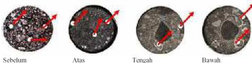
Gambar 6. Posisi batu sintesis pada pemadatan APRS sesudah 45 lintasan.
