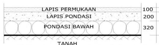
Gambar 3. Susunan perkerasan lentur
