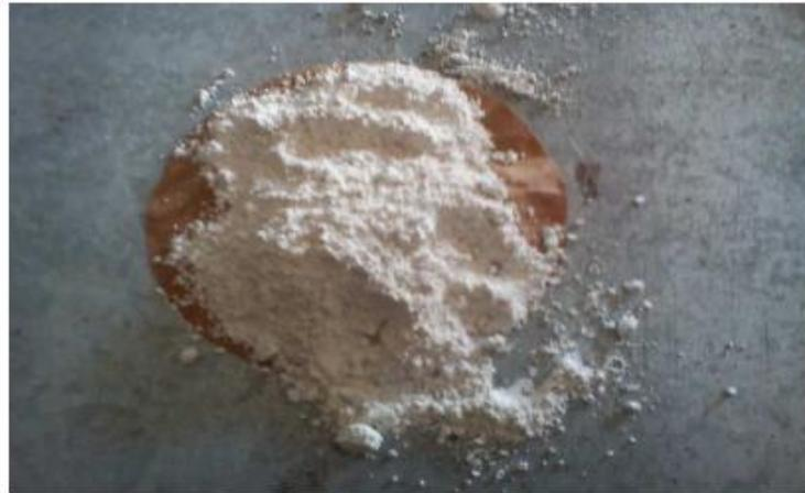
Gambar 1. Bentuk fisik dari bubuk kaolin
