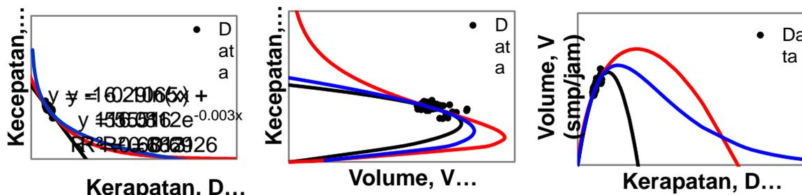
a. Model Hubungan S - D. b. Model Hubungan V - S. c. Model Hubungan V - D
