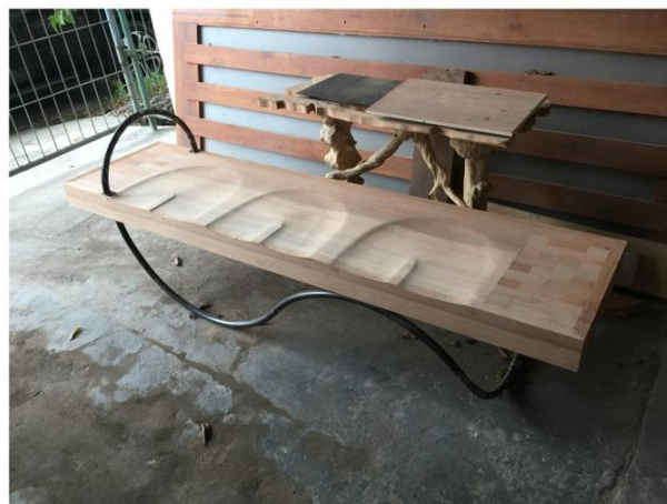
Gambar 10. Proses pengabungan komponen dudukan Pada rangka kaki besi(Sumber: Penulis,2019)
