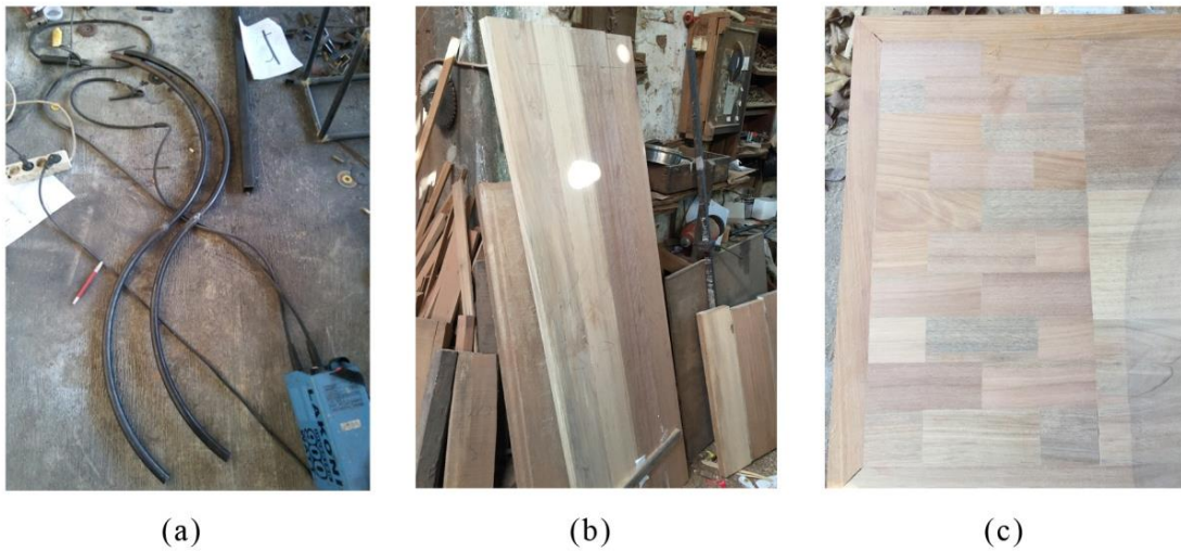
Gambar 9. (a) Proses pemotongan besi pipa, (b) Proses pemotongan kayu Nyatoh, (c) Proses pengolahan kayu-kayu bekas (Sumber: Penulis,2019)
