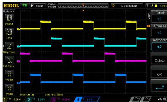
Gambar 6. Sinyal kontrol empat antenna
