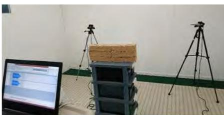
Gambar 13. pengujian panel akustik
