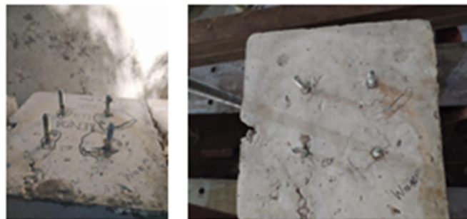
Gambar 3. Hasil pengujian pull-out
